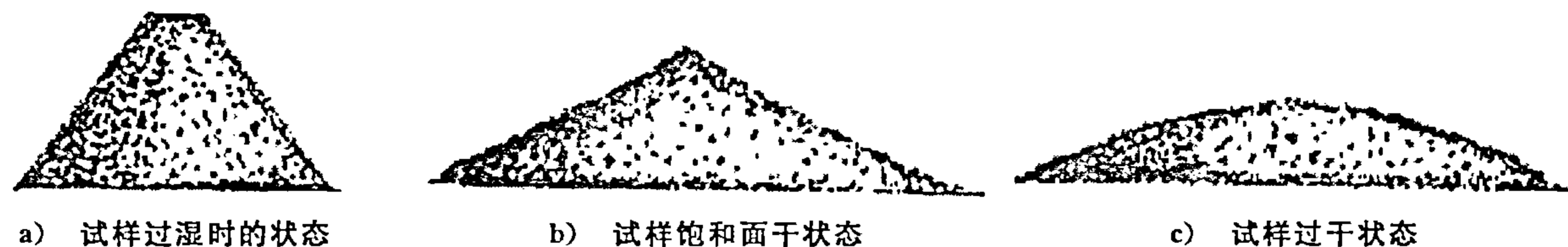
图4 天然砂饱和面干试样的状态
